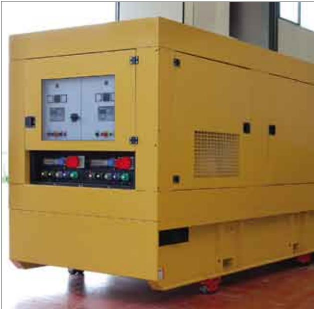
BIGRUPPO 2 x 150/135 in cofanatura 65 db(A) a 7 mt. con quadro di parallelo. Funzionamento: parallelo fra gruppi; a richiesta di carico; uno in emergenza all'altro.
